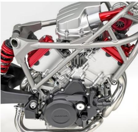
**64** Auf der EICMA zeigte Honda die Studie eines V3-Motor mit E-Kompressor
